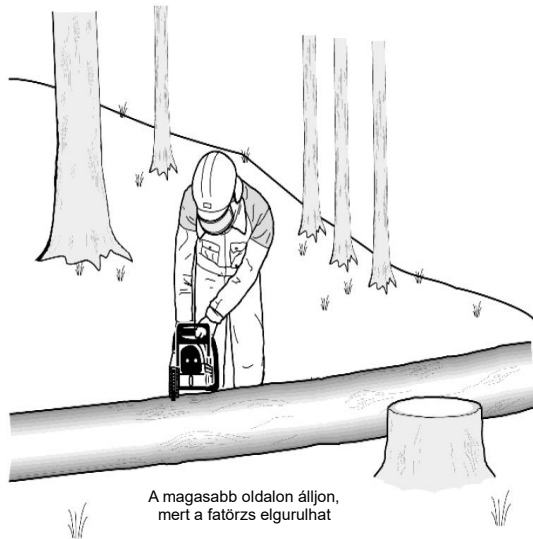
BB.107 ábra Fatörzs aprítása
