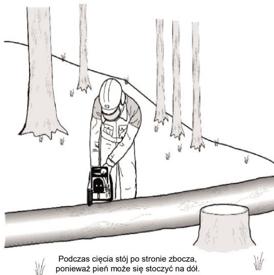
Rys. BB.107-Skracanie pnia
