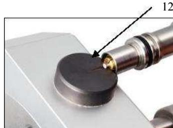
Řezací délku lze jemně nastavit mikrometrovým šroubem na vodiči elektrody. Jedno kolo odpovídá 1 mm.
