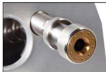
Pro odříznutí poškozené špičky elektrody, která nebyla broušena, použijte jednu ze sběračských špiček místo modulu převodníku. Zvolte vhodnou špičku sběrače pro průměr elektrody.
