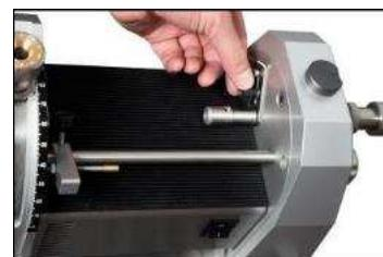
Aby nedošlo ke střikání brusné kapaliny z vodiče elektrod na brusné části, uvolnění převodníku (10) muže být umístěno ve vodiči elektrod.
