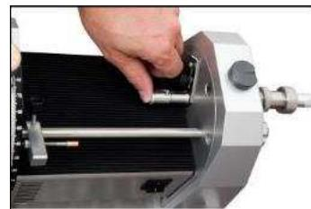
nebo uvolněním převodníku (10) (pro dlouhé elektrody) kde elektroda prochází převodníkem zajistěte, aby byla špička elektrody zajištěna v převodníku.
